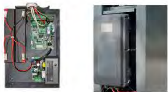
Upravljanje i kontrola Kontrolna i upravljačka jedinica je integrisana u telo rampe
